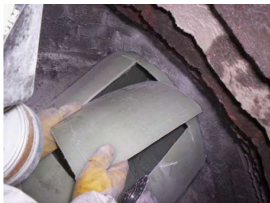
Bild 2, Förslag på uttag för 3-punktsböj
