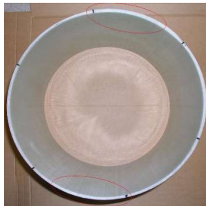
Bild 3, överlapp av vävar i färdig liner
